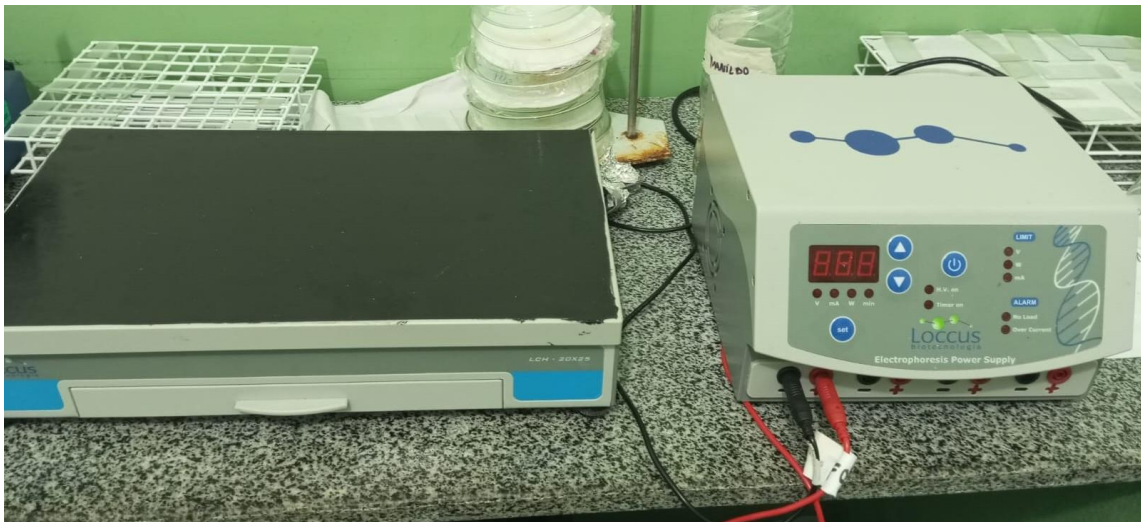
Fonte e cuba de eletroforese, Laboratório de Ecotoxicologia e Microbiologia Ambiental (LEMAM) – IFF Cabo Frio
