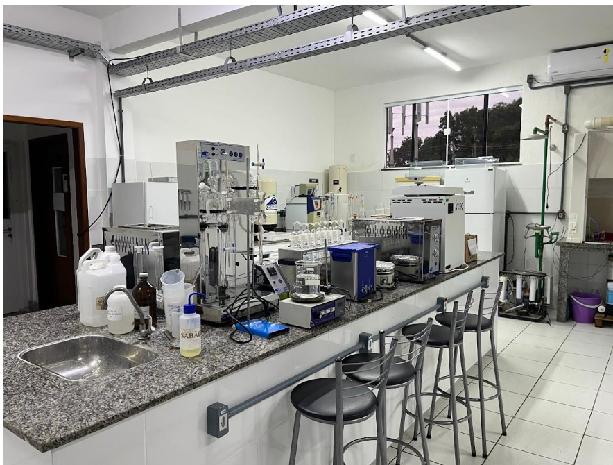
Bancada 2 da sala principal do LabFoz contendo placas de aquecimento e agitação (Warmnest HJ-5), destilador de nitrogênio Kjeldahl (Solab SL-74), exaustor de gases (Solab SL-191), banho de ultrassom (Elma S 40 H), autoclave de bancada (Digitale AV-50), dentre outros materiais.
