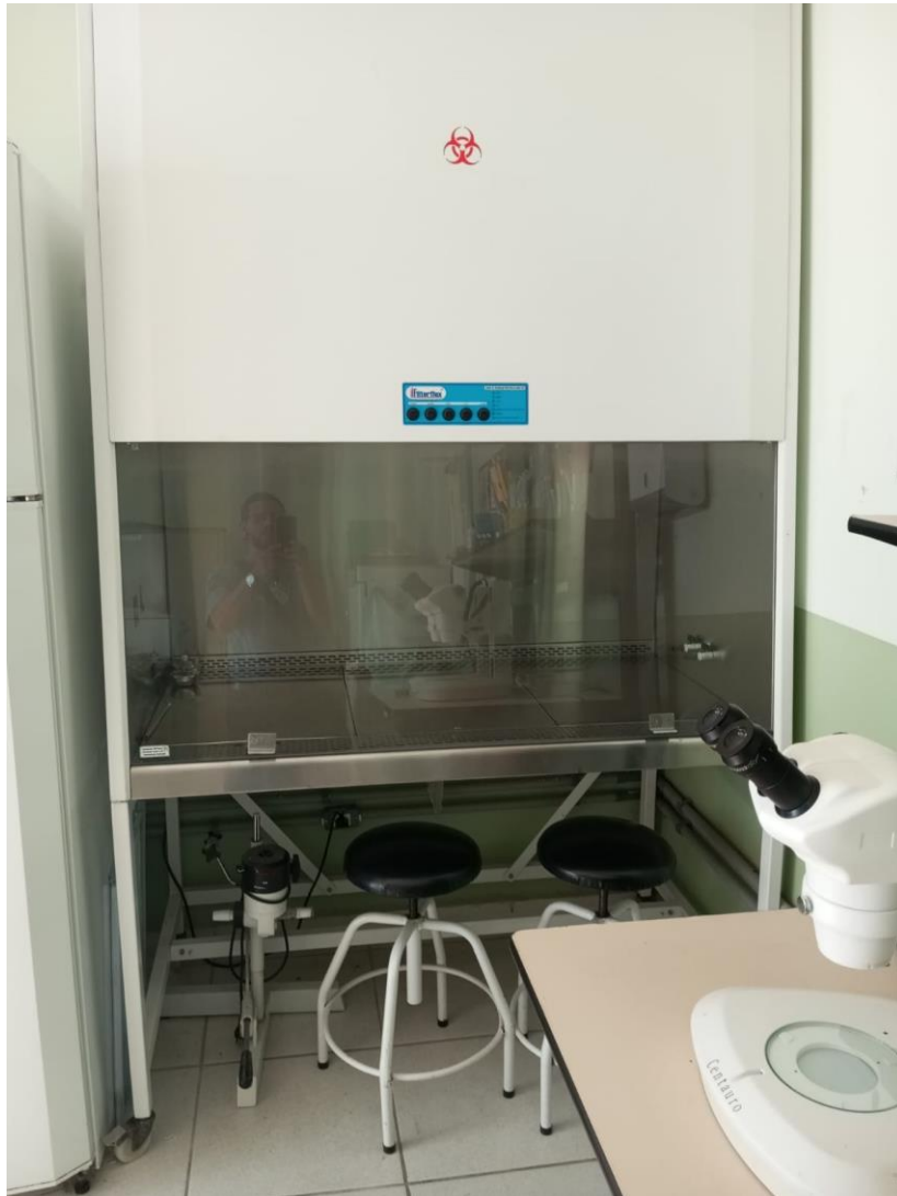
Câmara de fluxo Laminar Classe II, Laboratório de Ecotoxicologia e Microbiologia Ambiental (LEMAM) – IFF Cabo Frio
