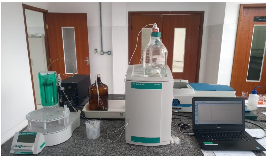
Cromatógrafo de íons da Metrohm (modelo 883 Basic IC Plus) acoplado ao amostrador automático (modelo 863 Compact Autosampler).
