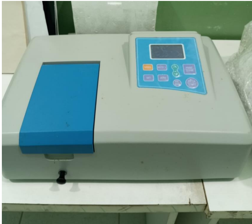
Espectrofotômetro UV-Vis; Laboratório de Ecotoxicologia e Microbiologia Ambiental (LEMAM) – IFF Cabo Frio
