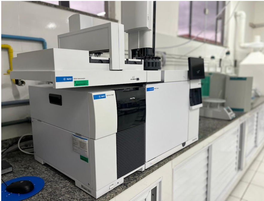
Cromatógrafo à gás (8890 GC System) acoplado ao espectrômetro de massas (5977B GC/MSD) com sistema de injeção automática da Agilent (7693A Autosampler).
