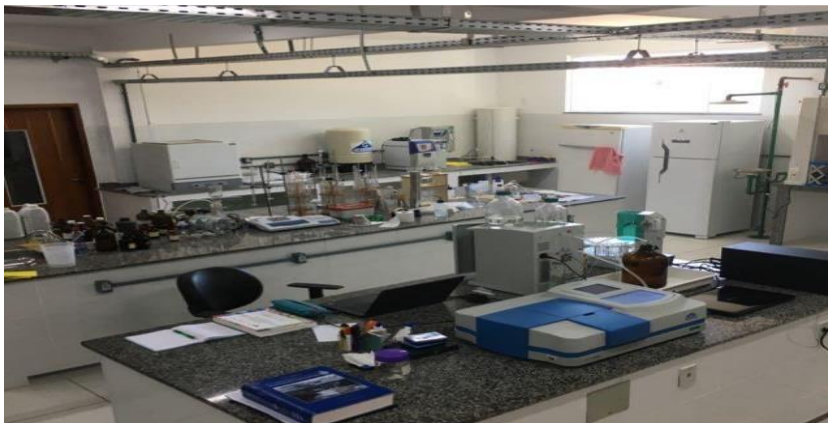
Bancadas 1, 2 e 3 da sala principal do LabFoz. Na bancada 1 encontra-se o Espectrofotômetro UV/Vis (GEHAKA UV-380G).
